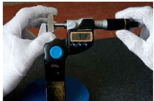
**Bügelmessschraube** mit analoger oder digitaler Anzeige
