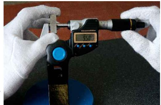
**Bügelmessschraube** mit analoger oder digitaler Anzeige
