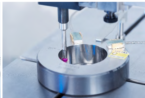
Einstellringe und Einstelldorne Durchmesser U = 0,1 \mu\text{m} + 1 \cdot 10^{-6} \cdot d Rundheit U = 0,1 \mu\text{m} + 2,5 \cdot 10^{-2} \text{RONt} Geradheit U = 0,2 \mu\text{m} + 2,5 \cdot 10^{-2} \text{STRt} Parallelität U = 0,4 \mu\text{m} + 1,5 \cdot 10^{-2} \text{PART}
