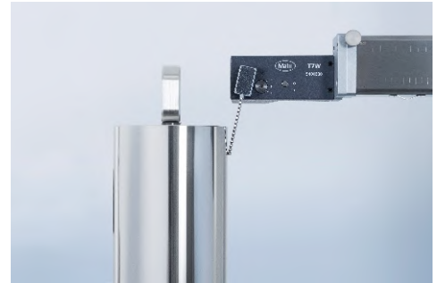
Prüfzylinder Rundheit U = 0,1 \mu\text{m} + 2,5 \cdot 10^{-2} \text{RONt} Geradheit U = 0,2 \mu\text{m} + 2 \cdot 10^{-2} \text{STRt} Parallelität U = 0,4 \mu\text{m} + 1,5 \cdot 10^{-2} \text{PART} Zylinderform U = 0,5 \mu\text{m} + 3 \cdot 10^{-2} \text{CYLt}
